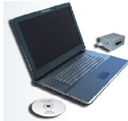
Digitális átalakító egység UPC-429-USB, hordozható számítógéppel
