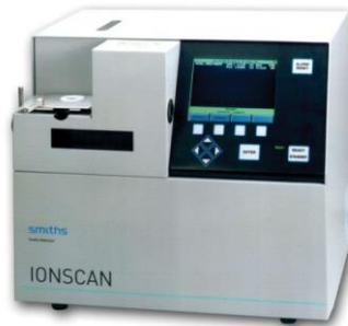
16. ábra IONSCAN 400 B drog és robbanóanyag felderítő berendezés [1]
