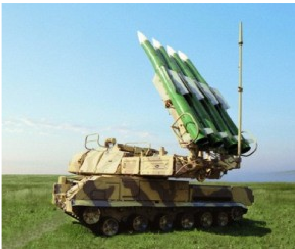
19. számú ábra: BUK-M1-2 légvédelmi rakéta-komplexum önjáró tüzegysége 63
