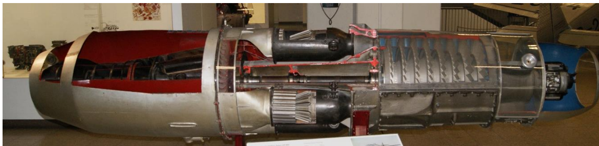
1. ábra: Jumo 004 típusú hajtómű égőterének metszete [40]
