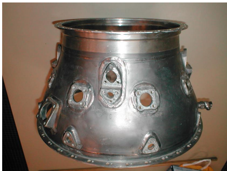
26. ábra: TV2-117A hajtómű égőterének diffúzor külső háza
