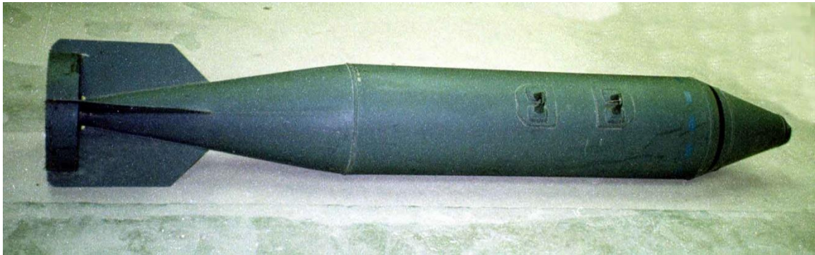
23. ábra RBK-250 egyszerhasználatos bombakazetta [65]
